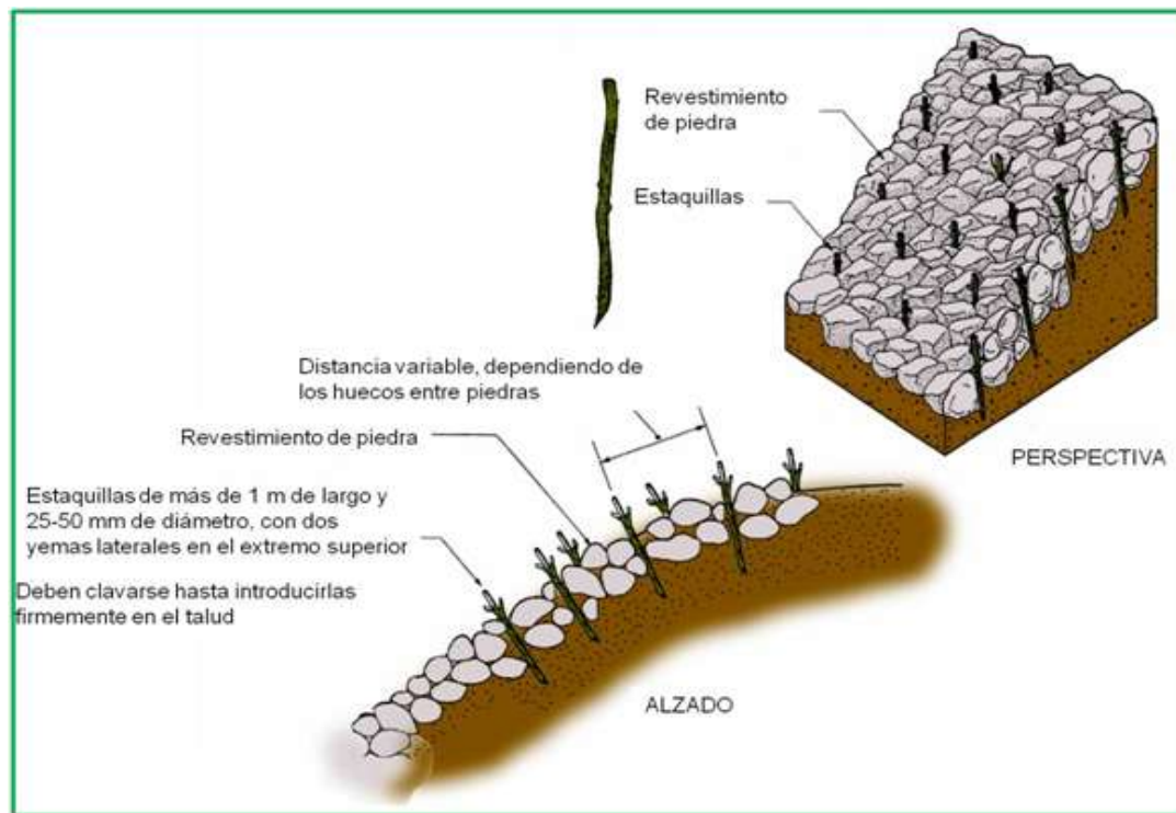
Fig. 43. Esquema de colocación de estaquillas en pedreras.
