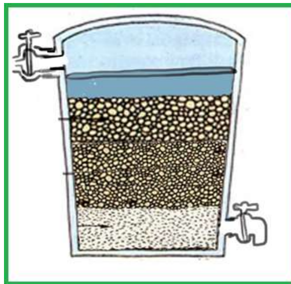
Fig. 23. Esquema de un filtro de arenas y uno de gravas.
