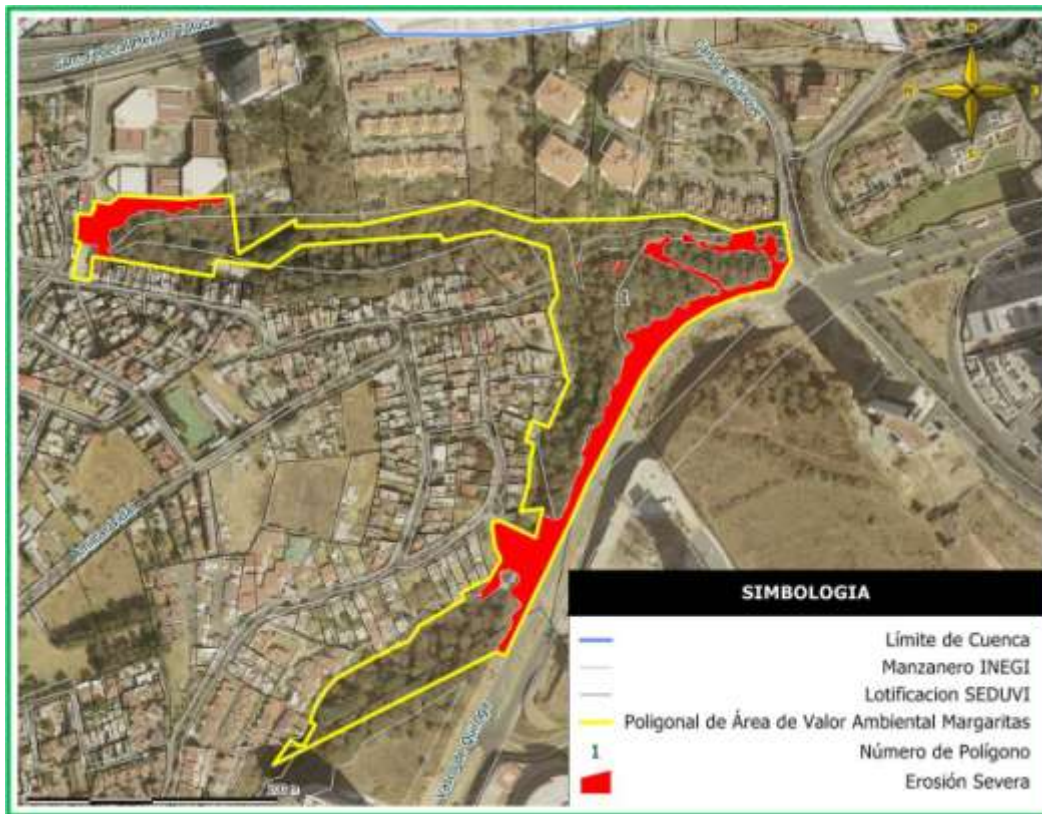
Fig. 11. Zonas que se han detectado con problemas de erosión severa dentro del AVA.
