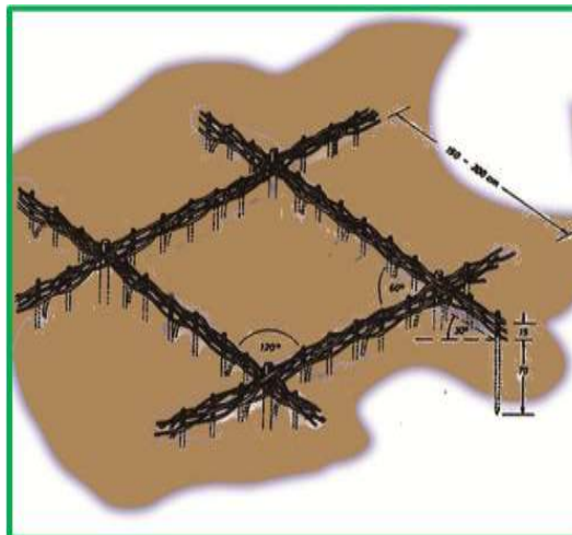
Fig. 40. Colocación en diagonal de empalizadas trenzadas.
