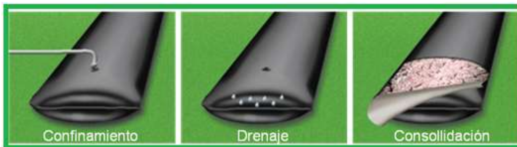
Fig. 22. Etapas del tratamiento de descargas residuales en geocontenedores.
